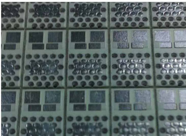
riplanarizzato come fosse un materiale normale visto dall'esterno, mentre già ingloba i vias. Ora il cliente può montare il LED su una piazzola che è già termoconduttiva, in senso verticale.
